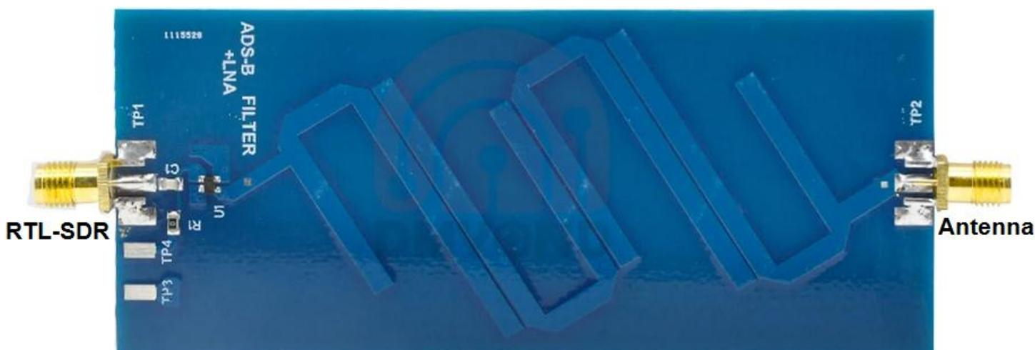
Le circuit doit être alimenté en 5V par une source extérieure. Après quelques modifications, il est possible d'utiliser le Bias-T intégré dans la clé Rtl-sdr **V3**.
