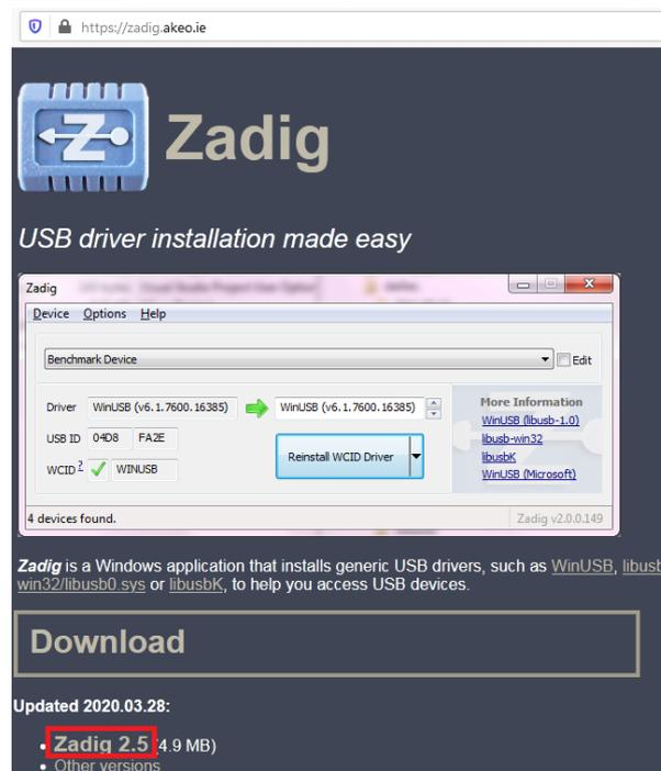
Brancher la clé rtl-sdr sur un port USB sur le PC. Il faudra veiller à toujours utiliser le **même port USB** pour la clé rtl-sdr. Exécuter le fichier
